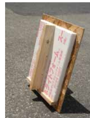
(後付け間柱取り付け)
